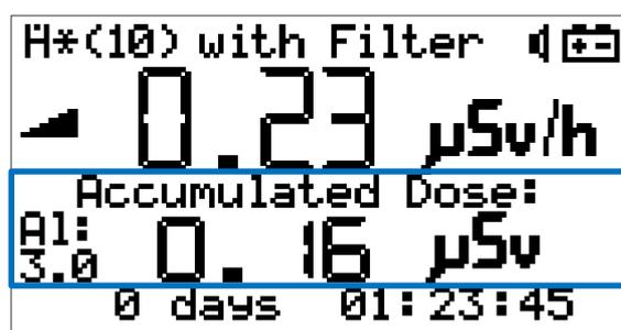
Die Umschaltung dieser Anzeigeoption erfolgt durch gleichzeitiges Drücken der Taste T4 ‚Mean‘ beim Einschalten des Gerätes.
