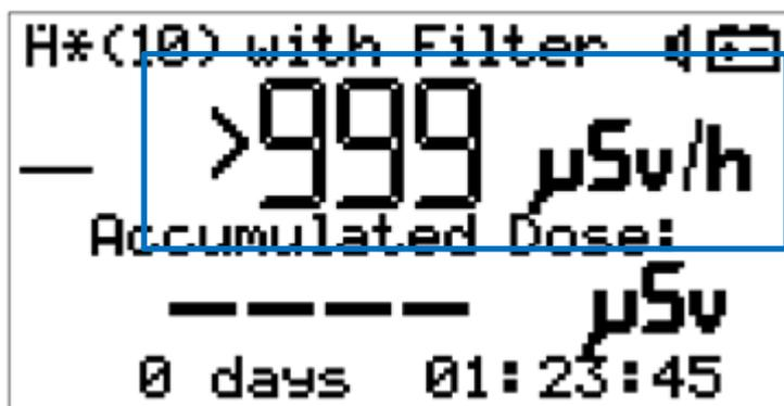
Extrem hohe Strahlenwerte können zu einer physikalischen Überlastung des Zählrohres führen. In diesen Fällen erscheint ebenfalls die „Überlauf“-Warnhinweis in der Anzeige in Verbindung mit einem Intervallton der Hupe.
