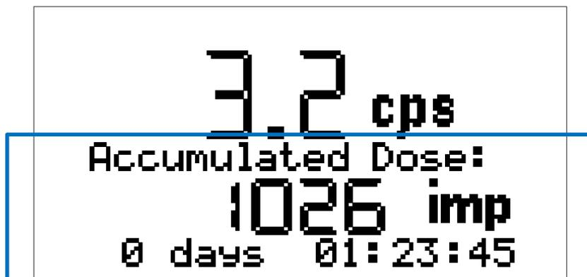
Diese Werte können durch langes Drücken der Taste 3 „Unit / Reset“ rückgesetzt werden.
