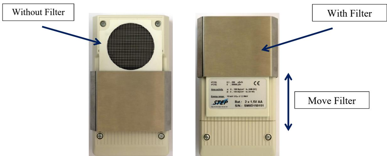
**Abb. 4** Rückseite des Survey Meter SM8D ohne (links) und mit (rechts)
