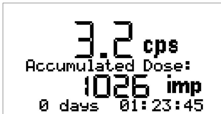
Im Impulsratenmessmodus werden zusätzlich kumulativ die im Verlauf der Zeit registrierte Impulsanzahl sowie die zugehörige fortlaufende Zeit im unteren Bereich des Displays angezeigt.
