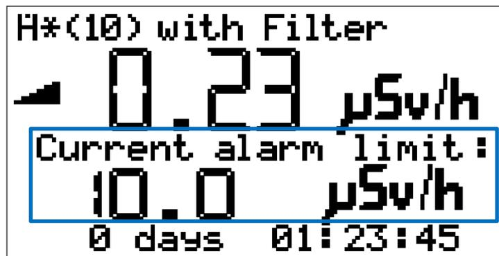
Durch kurzes Drücken auf Taste T4 , Mean' kann durch die fest vorgegeben Alarm-Grenzwerte gescrollt werden. Die Übernahme des Alarm- Grenzwertes erfolgt wieder durch langes Drücken von Taste T4 , Mean'.
