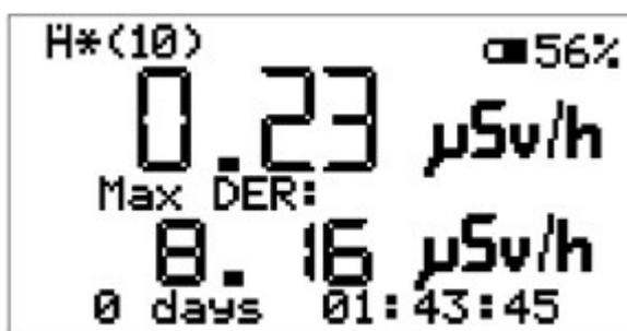
Fig. 16) Display in modalità misurazione  $\mu\text{Sv/h}$ .
