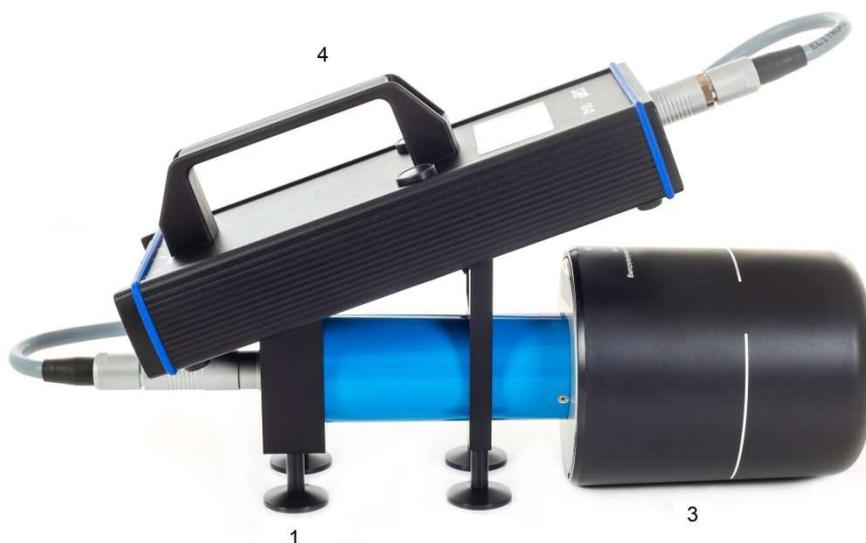
**Fig. 20)** Unità display e sonda applicate su supporto dispositivo
