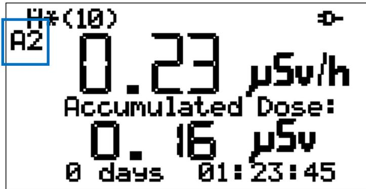
*Fig. 29) Soglia di allarme A2 raggiunta al momento (simbolo „A2“ lampeggiante)*
