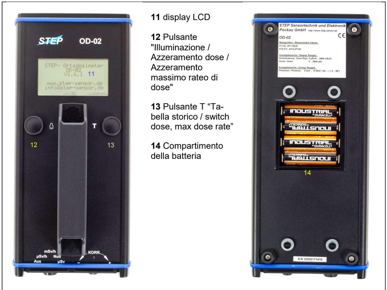
Fig. 3) Elementi di controllo lato anteriore e posteriore
