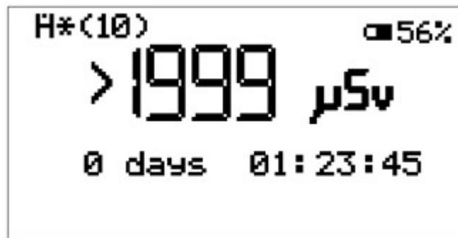
Fig. 18 b) Display superamento del range di misura in modalità "Dose".
