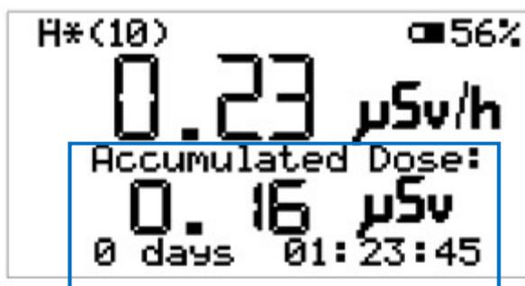
Fig. 7) Modalità "Dose rate" – Display dose accumulata
