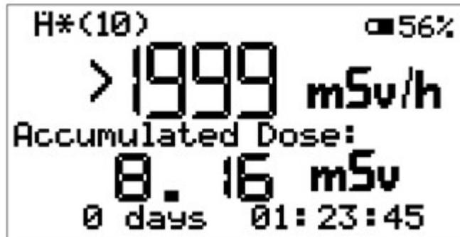
Fig. 18 a) Display superamento del range di misura in modalità "Dose rate".
