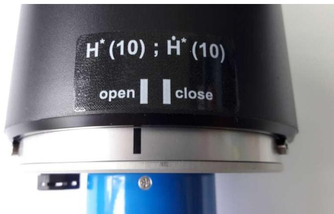
Fig. 14) Interlock del cappuccio di rinforzo
