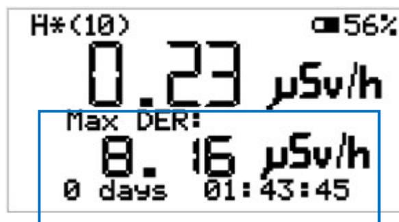
Fig. 8) Modalità "Dose rate" – Display Max dose rate
