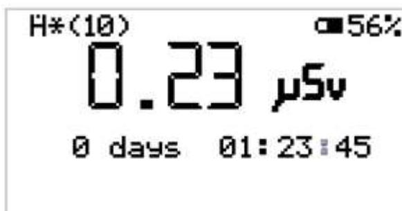
*Fig. 17) Display per la modalità di misura Dose  $\mu\text{Sv}$ .*
