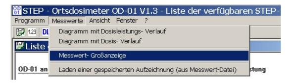
kann ein Fenster mit einer vergrößerten Darstellung des aktuellen Messwertes eingeblendet werden.
