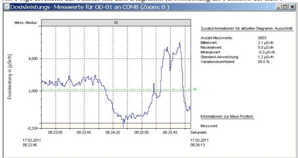
Dieses Fenster stellt im linken Bereich das selbst Diagramm dar. Im rechten Bereich werden genau zum sichtbaren Diagramm- Ausschnitt Zusatzinformationen eingeblendet:
