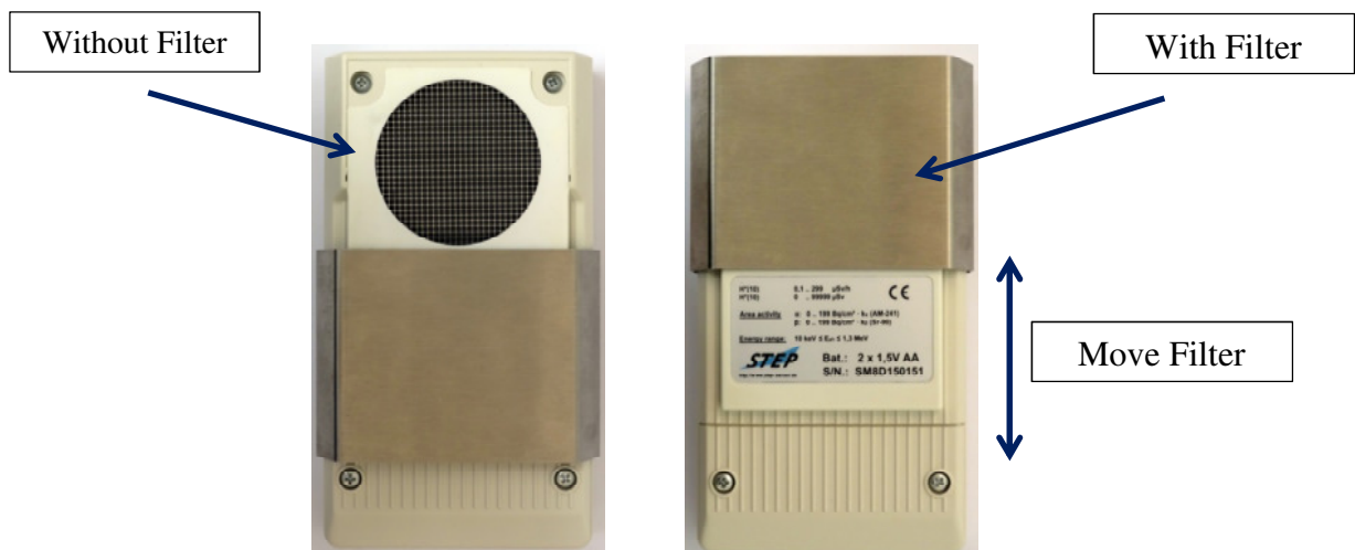
Abb. 4 Rückseite des Survey Meter SM8D ohne (links) und mit (rechts) aufgesetzten Energiekompensationsfilter.
